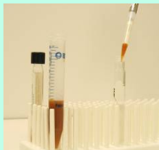
Agregue 0.25 mL de las QuickBeads al 6 mL de muestra concentrada
