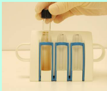
Recupere las micro-esferas utilizando un concentrador de partículas magnéticas (MPC)
