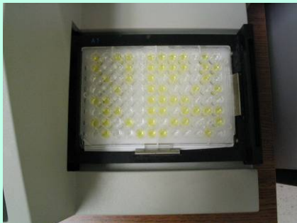
Lecture el plato de ELISA en el espectrofotómetro dentro de los 30 minutos contados a partir del momento en que se agrega la Solución Stop
