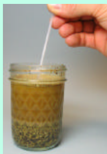
Al llenar la pipeta, evite las partículas sedimentadas al fondo de la jarra
